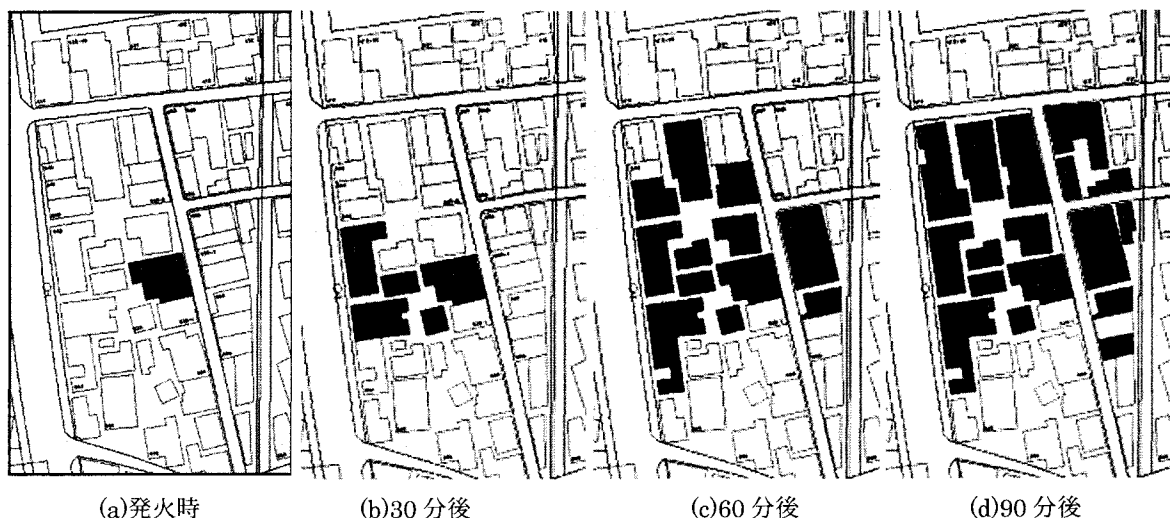
図-4 延焼シミュレーションの例
