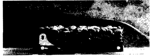
写真-1 越流型流れにおける水面形の一例
