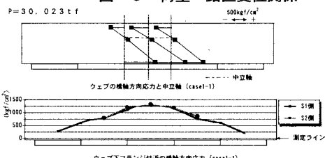
図-4 橋軸方向応力分布と中立軸位置
