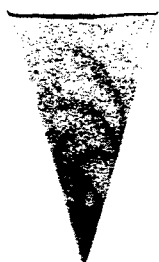
図 3 ケース A における密度変化図 ( Dr=78.6\% , t=5.5\text{sec} )
