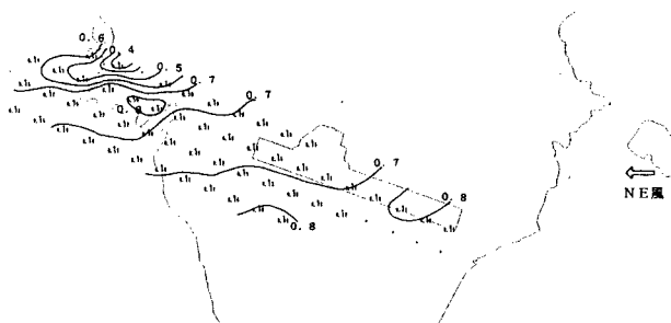
図-3 風洞実験結果 (高さ 20 m)
