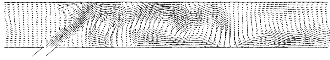
図-5 計算結果 (非線形 k-\epsilon モデルに Run 2 の Strain Parameter を導入)
