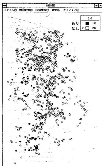
図 2 アンケートによる敷地内の地盤の沈みこみ
