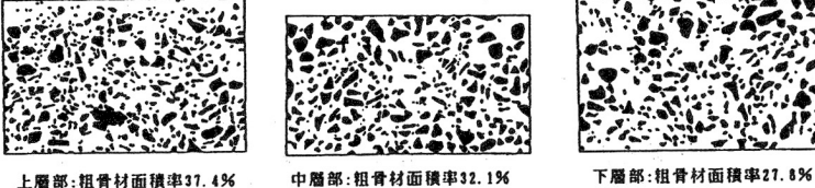
図-5 省力化施工コンクリートの粗骨材分布状況
