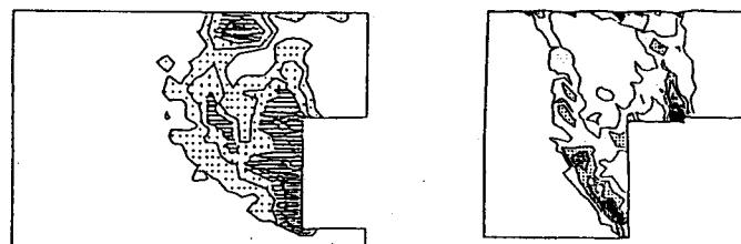
図-3 切羽から覆工までの距離の影響（土被りが浅い（1 D）の場合）
