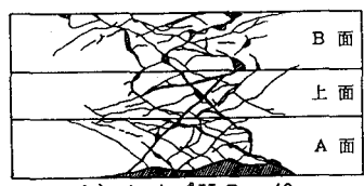
図-3 はりのひびわれ状況例
