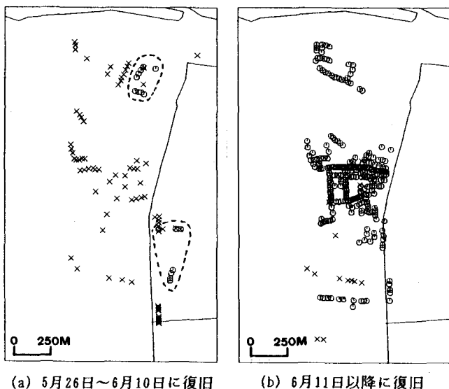
図2 配水管とガス低圧本支管の復旧箇所
