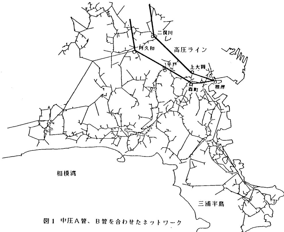
図1 中圧A管、B管を合わせたネットワーク
