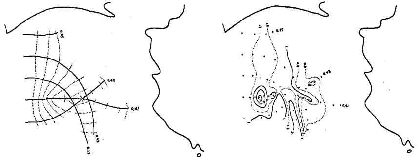
(a) 屈折図 実線:波向線, 虚線:フロント (b) 波高分布図
