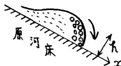
図-3 土石流 (I型) の概念図
