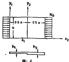
および周辺単純支持急変断面板の圧縮座屈(図-4)を例に選んで検討した。
