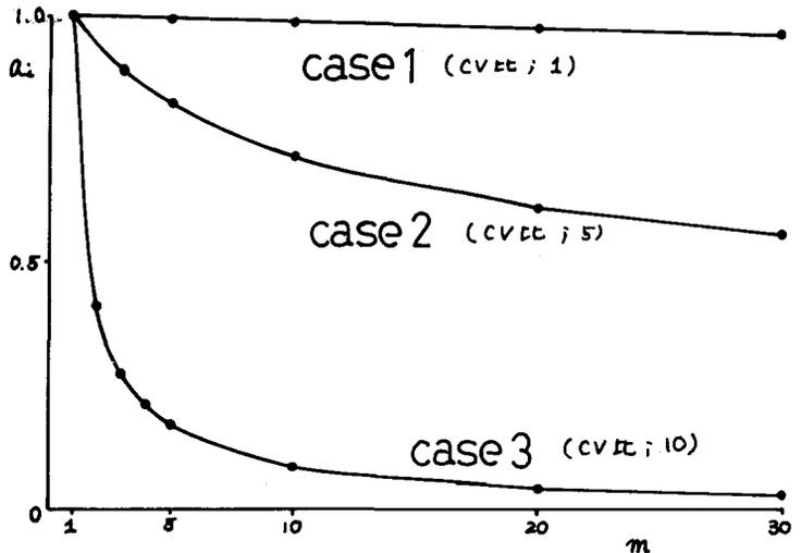
事は、各部材に導入される荷重は、値そのものはランダム量であっても、それらの間に関数的関係が存在するという事実と照らし合わせると、構造物のある破壊モードが残存すれば、ほとんど他の部材は安全であると考えるのと一致している。すなわち破壊モード間に完全な統計的従属性があると考えられる。この数値計算結果は、以上の推論にうまく合致したものである。
