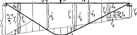
4. 1本のゲルバー桁の  $n_1 \sim n_2$  間の先端に1個の  $P_k$  が作用したときの任意の点のYとM。
