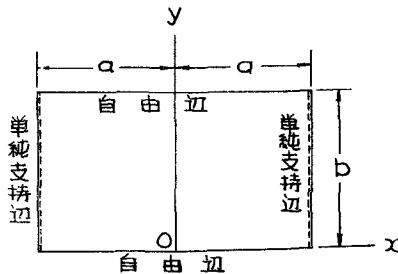
ただし、 $\alpha = 4.7300$ ,  $\beta = 0.98235$  であって、 $y$  方向のたわみの形は、両端自由な棒の最低次固有振動の形に相似なものと採用した。
