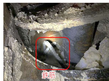
図-7 S/Cに挟まった鉄筋
