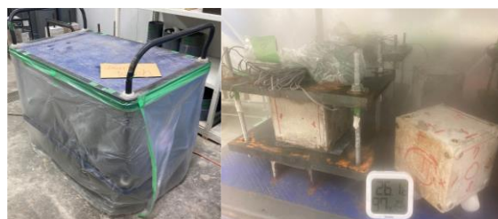
(a) 膨張試験環境 (b) シート内の様子 図-2 曝露の様子
