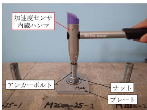
写真-1 打撃試験の状況
