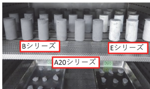
図-1 炭酸化養生の状況
