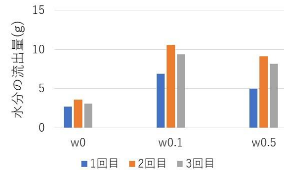
図-8 吸水透過試験による水分の流出量 (ひび割れ面…流入部)
