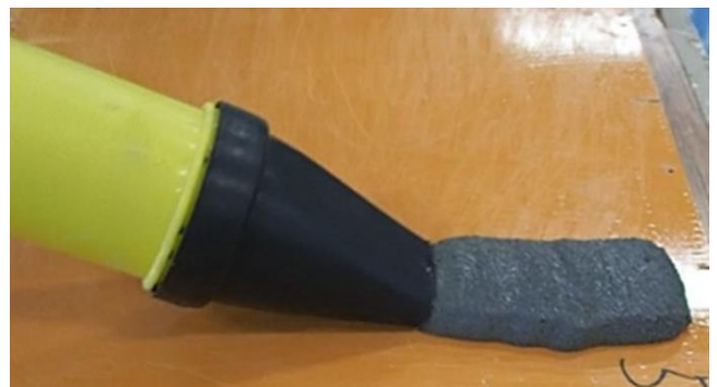
写真-1 モルタルガンによる模擬積層実験
