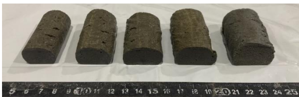
図-3 各移動速度のフィラメント供試体の断面
