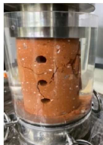
写真-1 飽和供試体の一軸圧縮試験の一例
