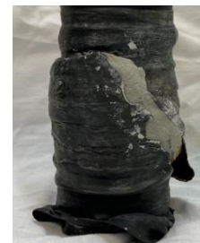
写真3 5.0MPa時の三軸試験後の供試体
