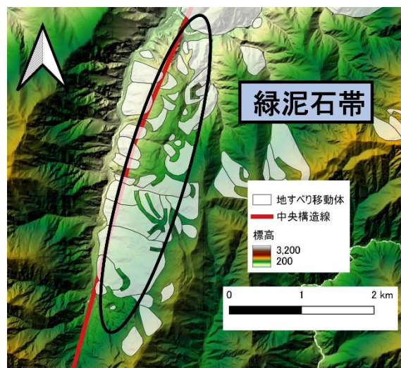
図4 南信濃地域の緑泥石帯が広がる地域の陰影段彩図と地すべり地形分布図を複合したマップ
