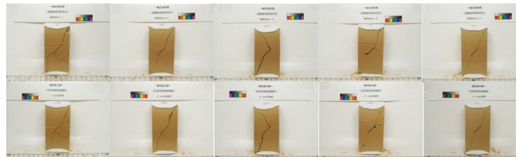
図-7 角柱破壊形態（初期亀裂長さ 20 mm, 上段：前面, 下段：背面を左右反転）
