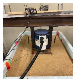
写真3 振動機設置完了図
