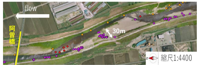
図-2 ドローン撮影画像の合成結果(36k~36.7k)とごみの停止位置。
