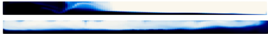
図-4 数値計算におけるタンク水の水面形 ( h_t = 5.2 mm) (上：タンク静止直後，下：同 1 秒後)
