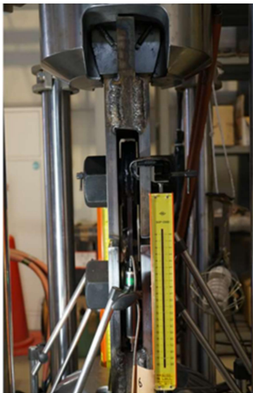
図-1 供試体と変位計設置後の様子
