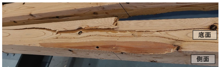
図-4 無補強試験体の下縁部の損傷状
