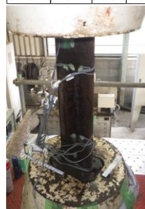
図-3 疲労試験状況
