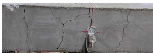
図-3 実験終了時の供試体状況
