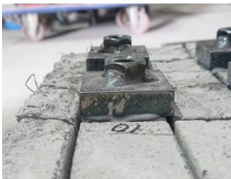
図-3 アタッチメントの取り付け状態
