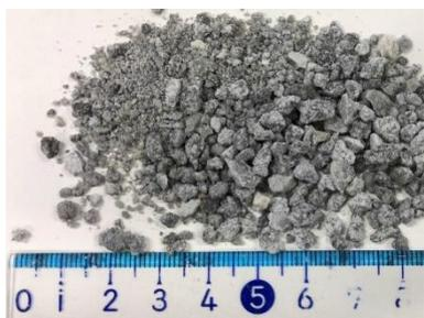
写真-1 FCS 細骨材の外景
