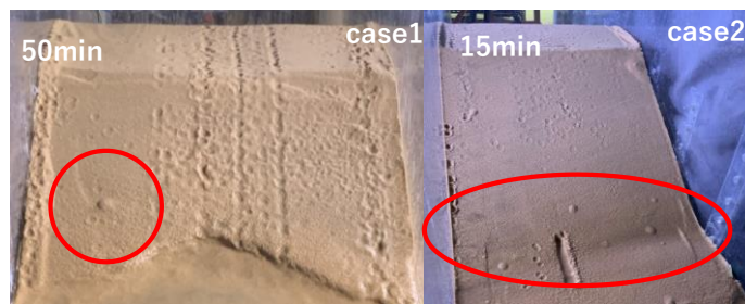
図-5 実験で確認されたエアブロー現象：左図；case1（降雨強度 30mm/h），右図；case2（降雨強度 90mm/h）
