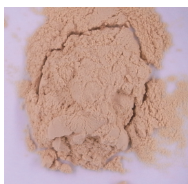
写真-4 T=200^{\circ}\text{C} による高温加熱試料の状態
