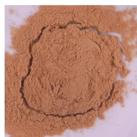
写真-4 T=200^{\circ}\text{C} による高温加熱試料の状態
