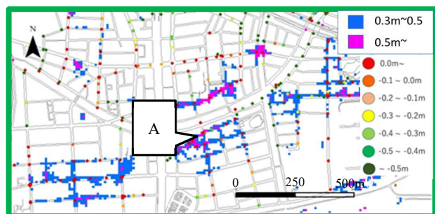
図-3 最大浸水深の分布（拡大図）と 地盤からみたマンホール内水位の値
