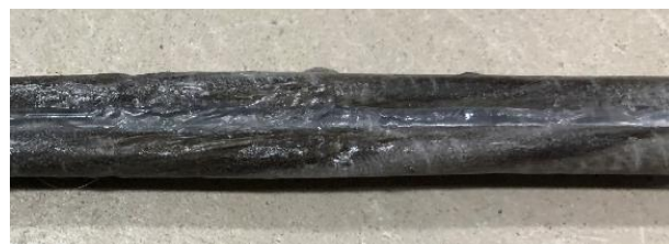
図 4 ポリプロピレンフィラメントによる接合状況
