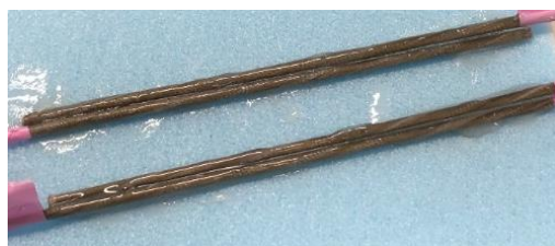
図 3 スチレンブタジエンゴム系溶剤系接着剤による接合状況
