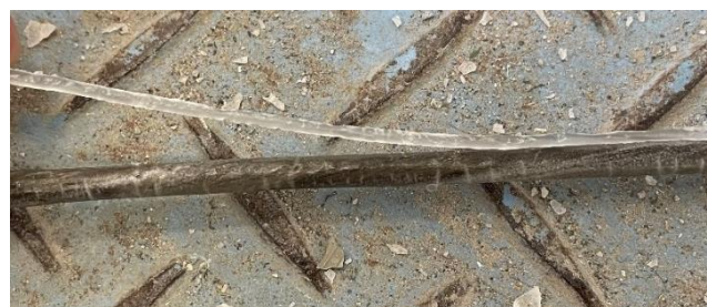
図9 接合が不十分であった箇所(ポリプロピレンフィラメント)
