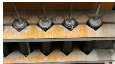
図 2 鋼管と静的破砕剤によるバサルトロッド端部の固定
