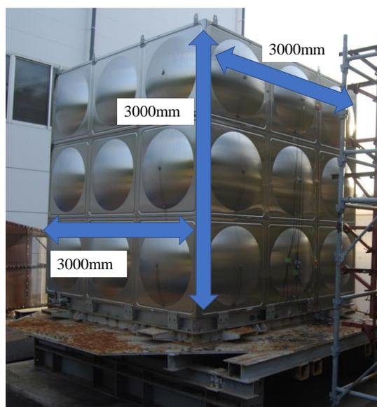
写真-1 実験に用いたステンレス鋼製矩形水槽
