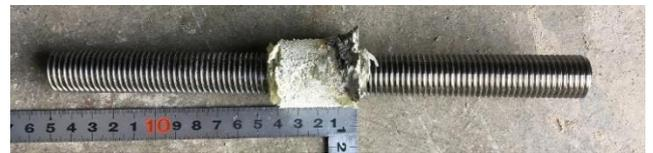
図-3 先端部未充填の引抜き後のアンカーボルト
