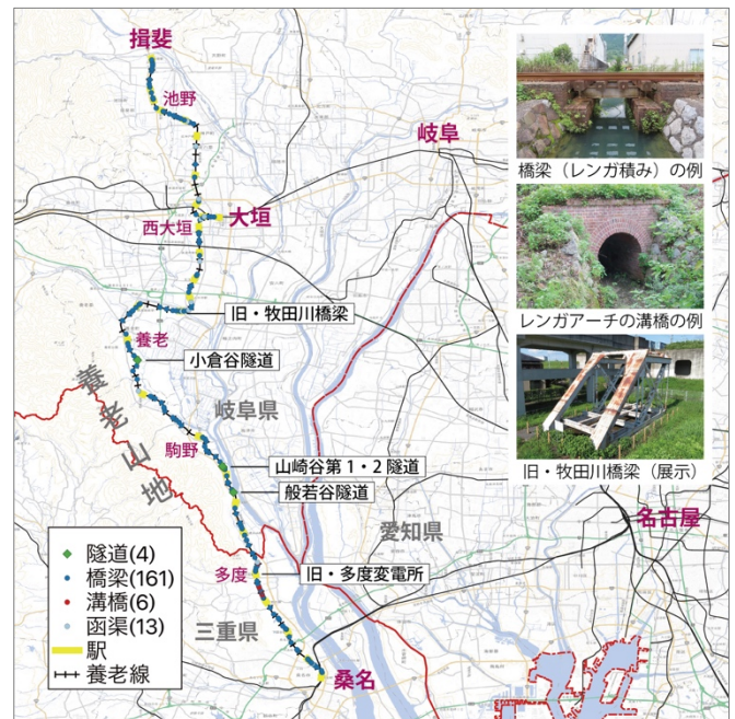
図-1 養老鉄道・養老線における土木構造物の概況
