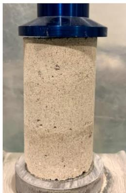
図-2 人工真砂土を用いた供試体
