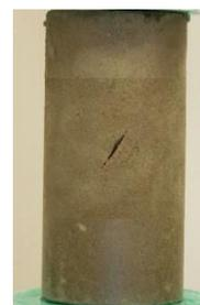
図-2 亀裂を挿入した円柱供試体
