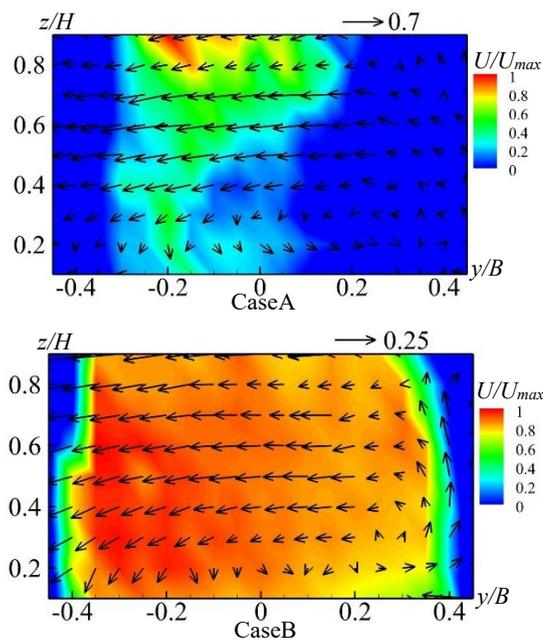
図-3 横断面 ( $x=120\text{cm}$ ) における主流速の等値線及び二次流ベクトル分布
