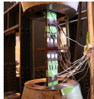
図-2 疲労試験状況
