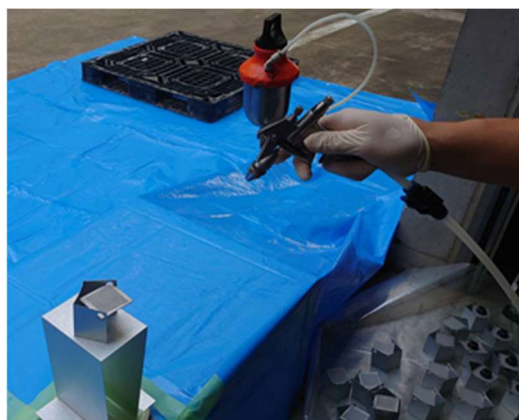
図-1 吹き付け塗布の様子
