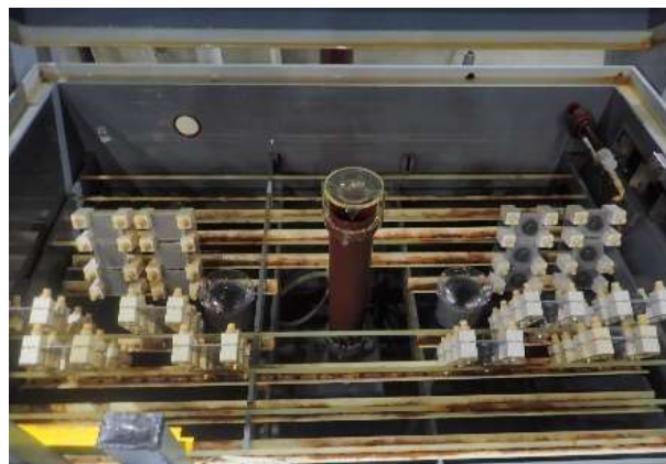
図-2 複合サイクル試験機槽内の様子
